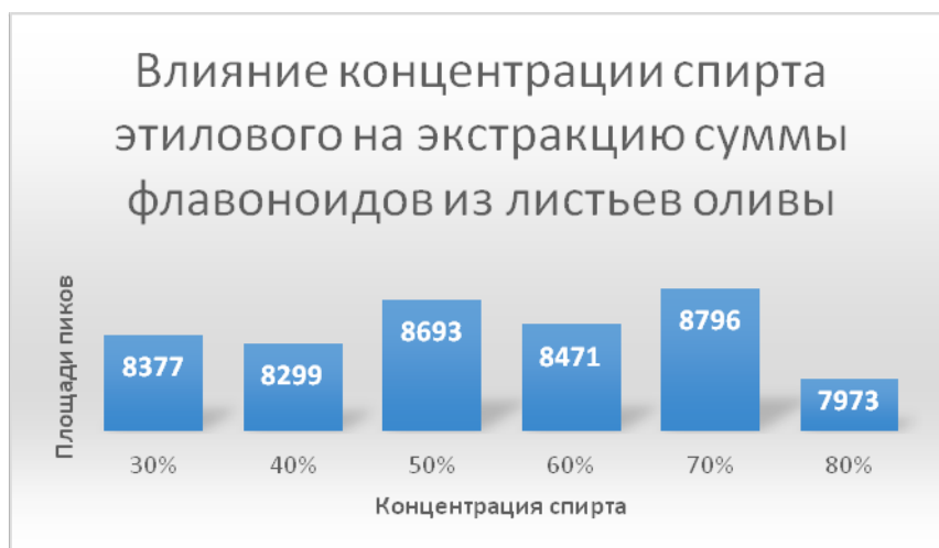
Рис. 1 – Влияние концентрации этилового спирта на содержание суммы флавоноидов в получаемом экстракте из листьев оливы
