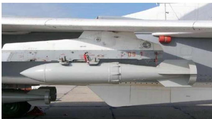
Рисунок 11.24 Бетонобойная авиационная бомба БЕТАБ-500
