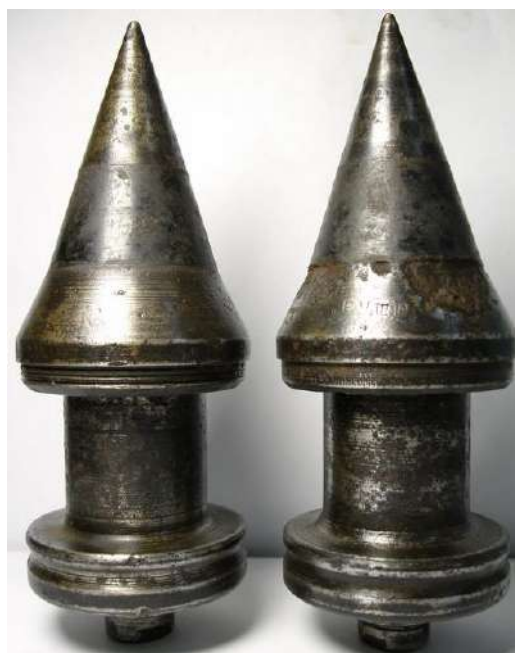
Рисунок 11.6. – Подкалиберные бронебойные снаряды
