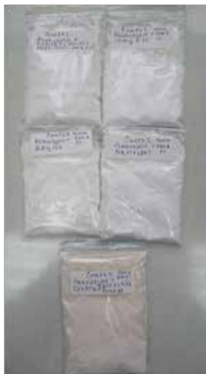
Смеси, которые хранили 4 недели при температуре (40 \pm 2)^\circ\text{C} и ОВ (75 \pm 5)\%
