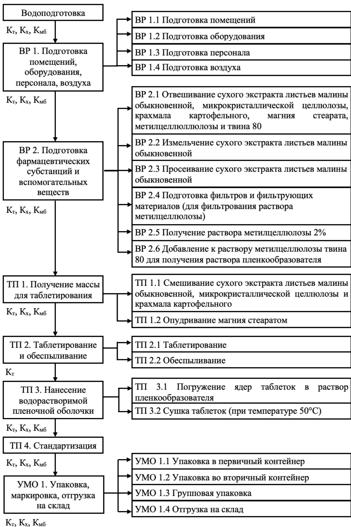
Рисунок 1 - Технологическая схема получения таблеток сухого экстракта листьев малины обыкновенной, покрытых водорастворимой пленочной оболочкой, способом прямого прессования
